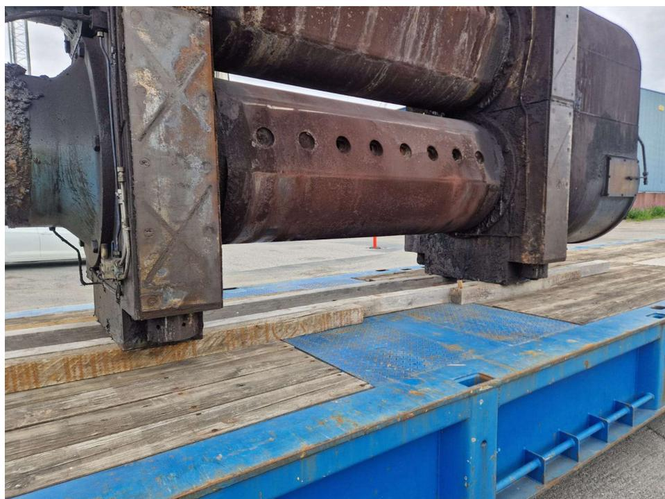
Das Problem für den Anschluss Transport per LKW stellte die hohe Punktbelastung dar. Das stellte an die Lastverteilung und die Ladungssicherung hohe Anforderungen. Deshalb wurde die Hanseskull GmbH mit der Beschaffung sämtlicher Materialien für die Lastverteilung sowie der Ladungssicherungsmaterialien betraut.
